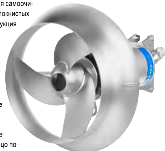
Опциональное струенаправляющее кольцо повышает КПД перемешивания.
